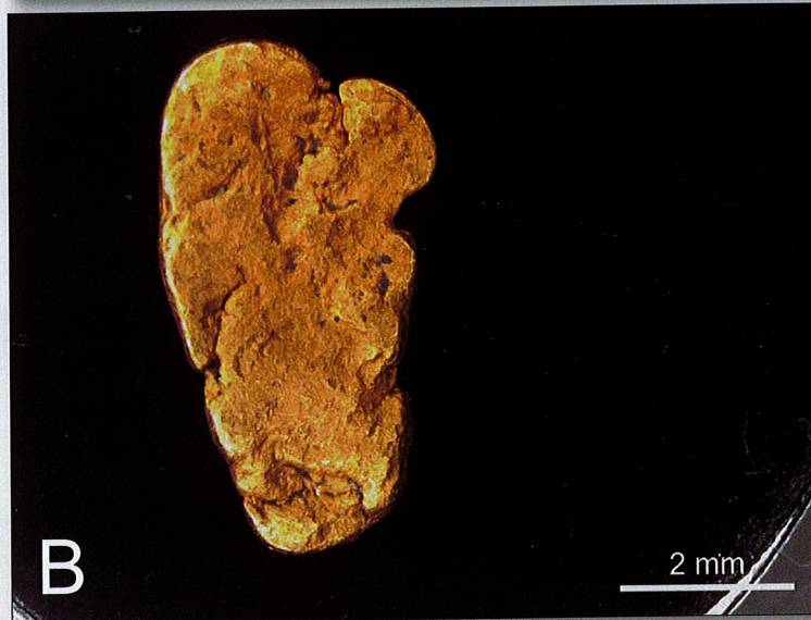
(A) or natif des Grandes Rousses et (B) or natif du Chéran prélevé en aval du pont de L'Abîme. Échantillons d'or inclus dans la résine époxy avant polissage ; la forme des paillettes du Chéran est plus aplatie et arrondie que celles des veines alpines : ceci est dû évidemment au transport fluvial.
