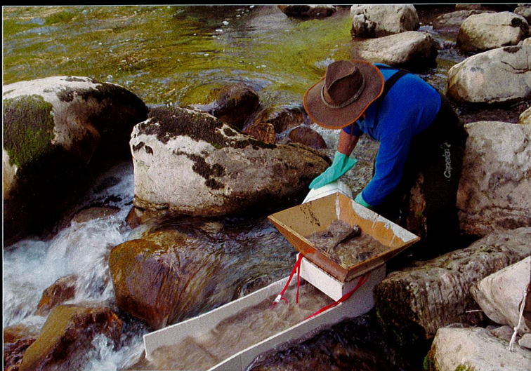
Démonstration par Daniel Parisey de l'utilisation d'une rampe de lavage (sluice) construite par ses soins
